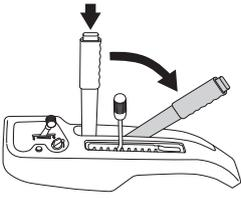
Этот рычаг можно также использовать для временного регулирования высоты резки, например на небольшом бугре на газоне.
