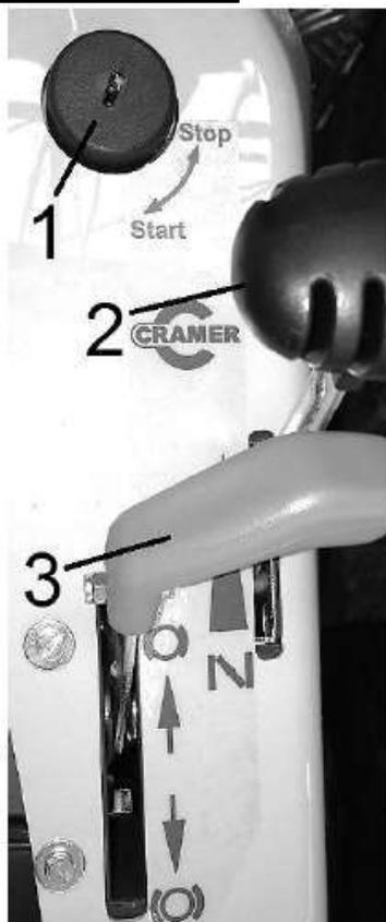
1. Стартер (замок зажигания)
